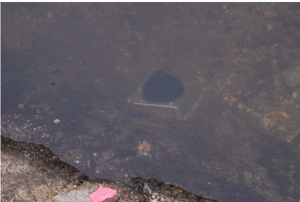
Die Sensoren der OTT Sonicflow Kreuzpfadanlage befinden sich kurz über der gepflasterten Gewässersohle (Foto: Hydrotec Berlin)
